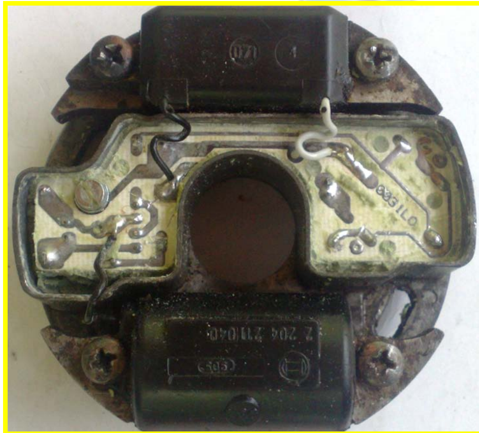
la centralina con le piste rifatte le nuove viti ed il termorestringente.
