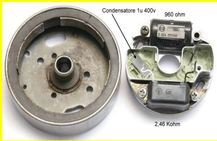
il volano (sulla sinistra ) e l'involucro che contiene la scheda elettronica
